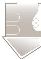
Sostituzione di un piatto doccia 90x90 con uno in pietra acrilica con superficie adattata alla necessità del perimetro sul quale doveva essere installato e creazione di una consolle con piano di appoggio, per sostituire un semplice lavamani.
