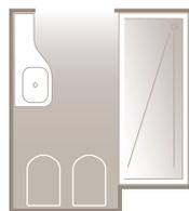
Sostituzione di una vasca 70x170 con un piatto doccia su misura per essere adattato alla nicchia lasciata libera. Inserimento di una consolle con piano di appoggio in sostituzione di un lavabo standard.
