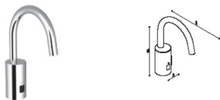
Miscelatore elettronico G10 comfort touch-free, con miscelazione, duplice sensore infrarosso, valvola selenoide, regolazione della temperatura, protezione antiscottature regolabile, risciacquo igienico regolabile 12 o 24 ore, flessibili adduzioni resistenti all'alta pressione, batteria 6V litio con durata fino a 4 anni, scarico automatico e piletta.
