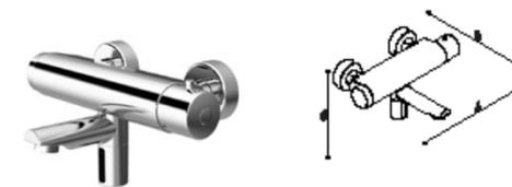
Miscelatore termostatico elettronico dotato di duplice sensore infrarosso; valvola solenoide; regolazione della temperatura con cartuccia termostatica anti-scottature; risciaquo igienico 24 ore; batteria al litio da 6V con durata fino a 4 anni.
