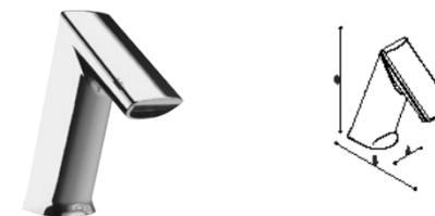
Miscelatore elettronico GM10 public touch-free, con duplice sensore infrarosso, valvola selenoide, regolazione della temperatura, protezione antiscottature regolabile, risciacquo igienico regolabile 12 o 24 ore, flessibili adduzioni resistenti all'alta pressione, batteria 6V litio con durata fino a 4 anni.
