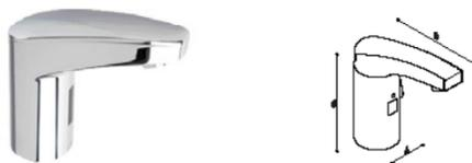
Miscelatore elettronico M10 basic touch-free, con duplice sensore infrarosso, valvola selenoide, regolazione della temperatura, protezione antiscottature regolabile, risciacquo igienico regolabile 12 o 24 ore, flessibili adduzioni resistenti all'alta pressione, batteria 6V litio con durata fino a 4 anni.
