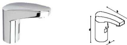
Miscelatore elettronico M10 basic touch-free, con duplice sensore infrarosso, valvola selenoide, regolazione della temperatura, protezione antiscottature regolabile, risciacquo igienico regolabile 12 o 24 ore, flessibili adduzioni resistenti all'alta pressione, trasformatore alimentazione a rete 230/6V.
