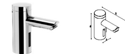
Miscelatore elettronico L10 comfort touch-free, con sensore infrarosso, valvola selenoide, regolazione della temperatura antivandalo, protezione antiscottature regolabile, risciacquo igienico regolabile 12 o 24 ore, flessibili adduzioni resistenti all'alta pressione, batteria 6V litio con durata fino a 4 anni, completo di scarico automatico e piletta.
