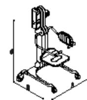
L'articolo viene fornito completo di poggia schiena, seduta, coppia di braccioli ribaltabili con impugnatura, per contenimento laterale. Portata massima 185 kg. Escursione in altezza del piano 600mm
