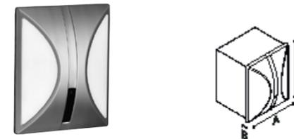
Rubinetto elettronico esterno per orinatoio U10 touch-free, con sensore infrarosso, cellula fotovoltaica e batteria 6V litio con durata fino a 10 anni, valvola solenoide, risciacquo igienico 24 ore.
