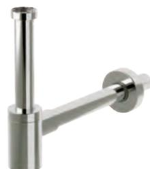
L'articolo interamente realizzato in acciaio inossidabile - AISI 304 - presenta un corpo, con tubo di alzata lungo 115 mm., ispezionabile, che sviluppa per un'altezza di 86 mm.
