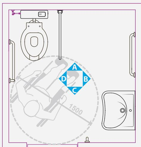
**Disposizione "tipo" di un bagno per disabili, allestito con vaso sanitario e lavabo. Posizioni e misure a norma di legge e consigliate**
