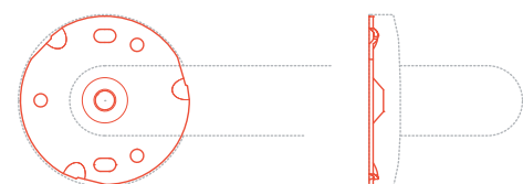
flangia 3 fori Acciaio inox - AISI 304, ø 80 mm
