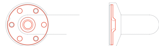
flangia 6 fori Acciaio inox - AISI 304 ø 70 mm
