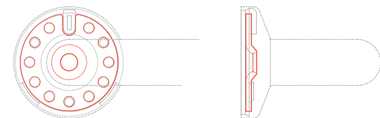
flangia 11 fori Acciaio inox - AISI 304, ø 80 mm
